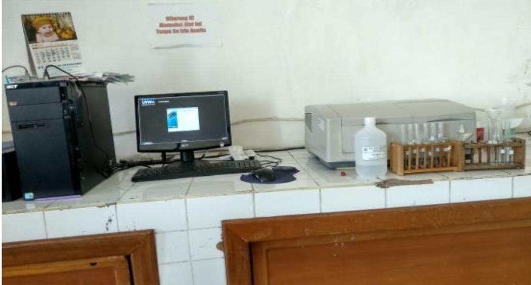
**Gambar 27. Seperangkat alat spektrofotometer UV-Vis**
