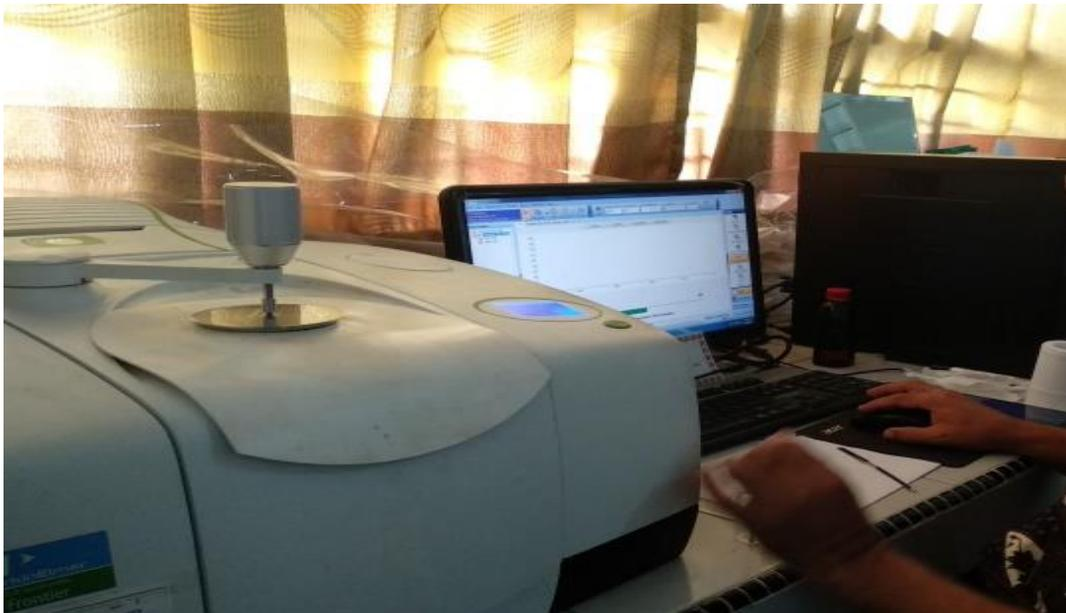
**Gambar 28. Seperangkat alat spektrofotometer IR**
