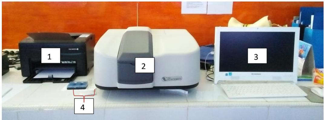
**Gambar 21. Alat Spektrofotometer UV-Vis**
