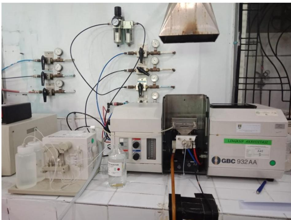
**Gambar 10. Alat Spektrofotometer Serapan Atom merek GBC tipe AA-932 dan Spektrofotometer Uap Dingin merek GBC Hg 3000 tipe 3000.**
