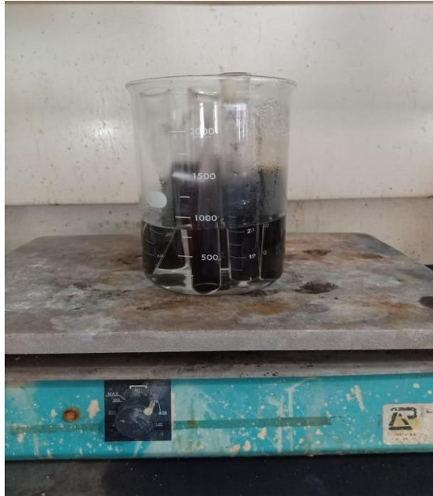
**Gambar 4. Pemanasan Pada Destruksi Sampel**
