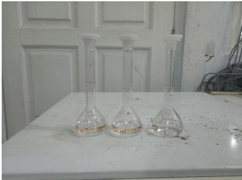
**Gambar 5. Hasil Sampel Setelah Destruksi+ Hidroksilamin-NaCl**
