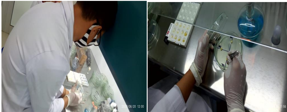
Gambar 3: Peneliti meletakkan kertas cakram dengan masing-masing konsentrasi pada media MHA yang telah diberi bakteri.
