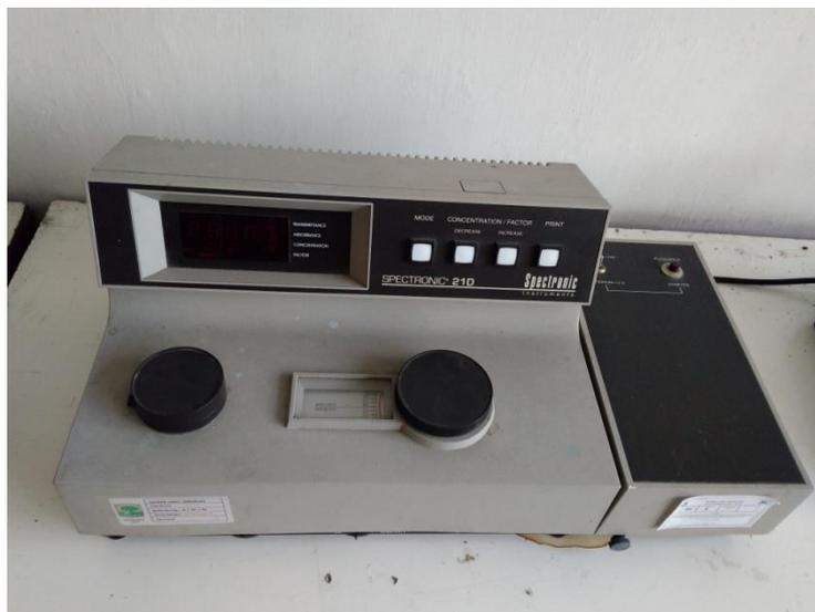
**Gambar 21. Spektrofotometer UV-Vis (Spektonik 21D)**
