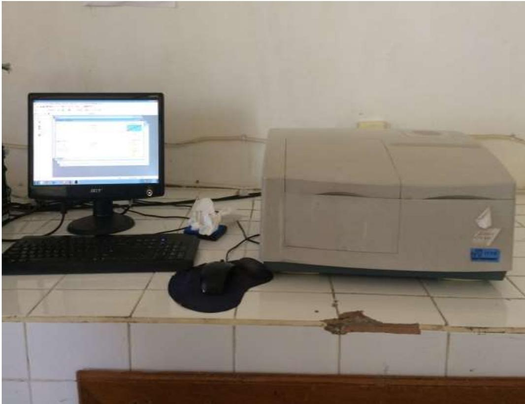
**Gambar 24. Instrumen Alat Spektrofotometer UV-Vis**
