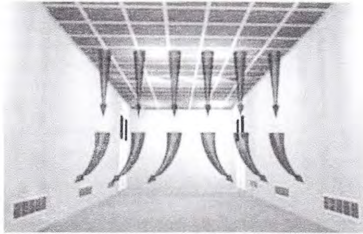
Gambar 4. Pengusiran Udara Kotor dengan Aliran Udara Satu Arah
