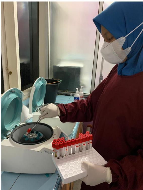
**Centrifuge sample darah selama 15 menit dengan kecepatan 3000 rpm**
