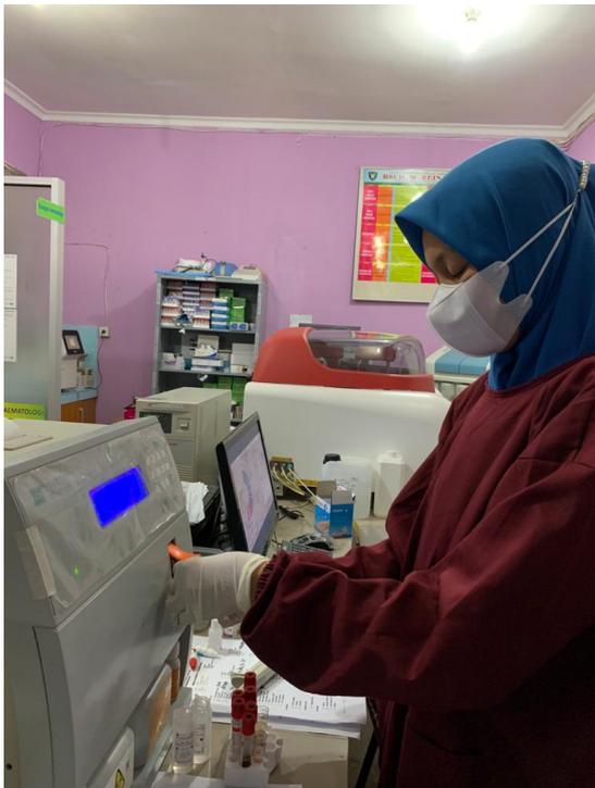
**Buka pintu probe, jarum probe secara otomatis akan menghisap sampel. Kemudian tutup pintu probe dan bersihkan dengan tisu.**
