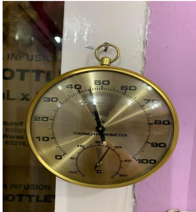
Gambar 18. Termohygrometer
