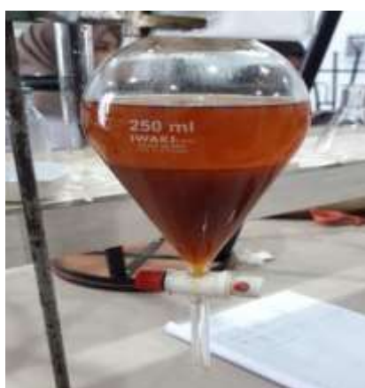
Gambar 28. Pemisahan Lapisan Air dan N- Butanol
