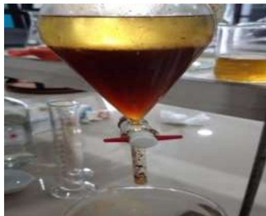
Gambar 25. Pemisahan Lapisan Air dan Etil Asetat
