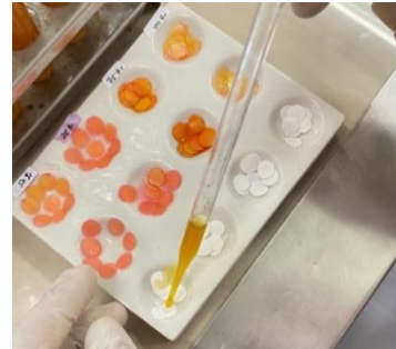
Peneliti memberi ekstrak kayu secang kombinasi dengan ekstrak lidah buaya, ekstrak tunggal kayu secang, dan ekstrak tunggal lidah buaya, pada cakram dengan konsentrasi masing-masing 25 mg/ml, 50 mg/ml, 75 mg/ml, 100 mg/ml.
