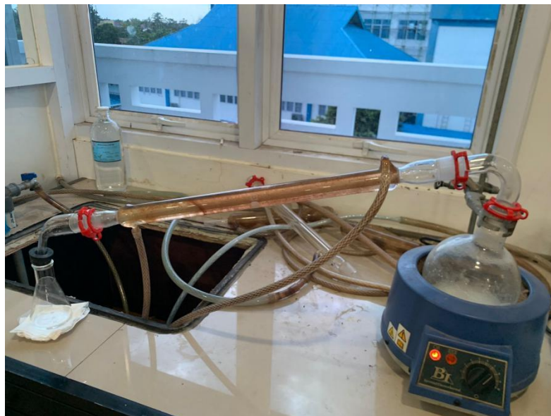
Gambar 10. Alat Destilasi Sampel untuk Perolehan KCN
