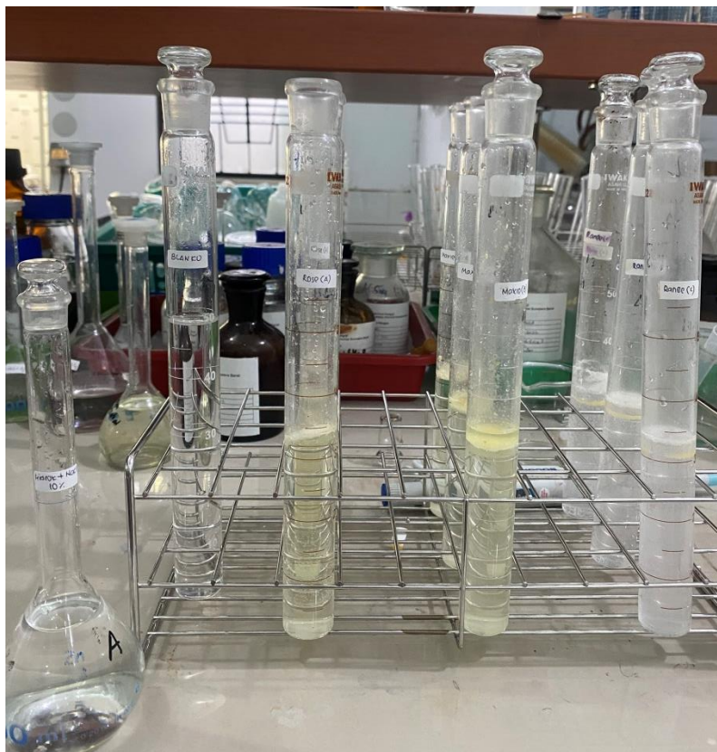
Gambar 8. Hasil Sampel Setelah Destruksi Basah
