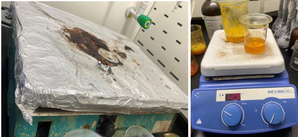
Gambar 7. Alat Destruksi Basah (Penangas Listrik)
